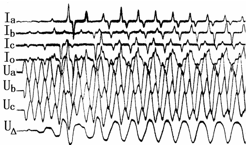
(a)发生基波谐振示波图 最大过电压倍数2.5，过电流倍数40.6 (b)加XXQ3消谐器后 不再发生谐振
