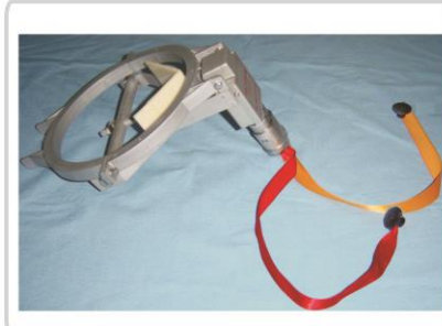
LPZ2型高压输电线路绝缘子 雷击闪络/污闪双指示器
