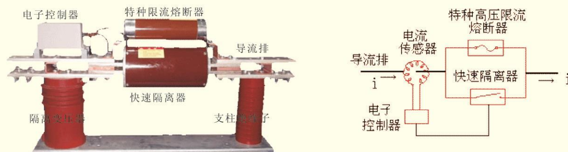
图1 单相产品外观及原理接线图
